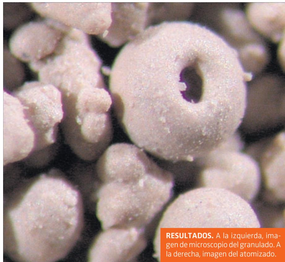
**RESULTADOS.** A la izquierda, imagen de microscopio del granulado. A la derecha, imagen del atomizado.
