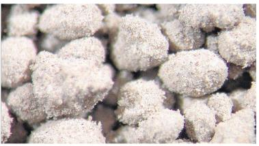
**RESULTADOS.** Arriba, imagen de microscopio del atomizado. Abajo, imagen de microscopio del granulado obtenido con el sistema de la firma.
