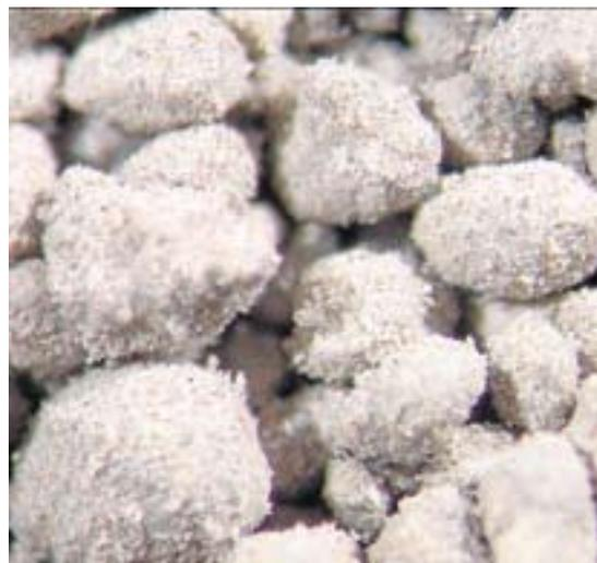
**RESULTADO.** A la izquierda, imagen de microscopio del atomizado. A la derecha, imagen de microscopio del granulado obtenido con la innovadora tecnología industrial desarrollada por Granulation System, protegida por patente nacional e internacional.
